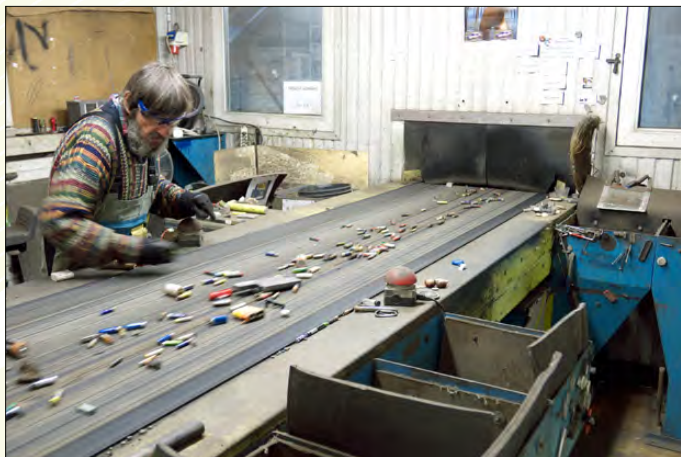
Handsortierung der Batterien.
